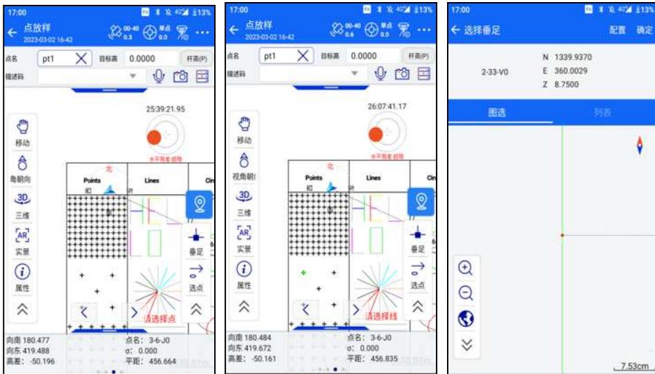
5、选择切点：可获取点和圆弧/圆/曲线的切点，进行点放样。
