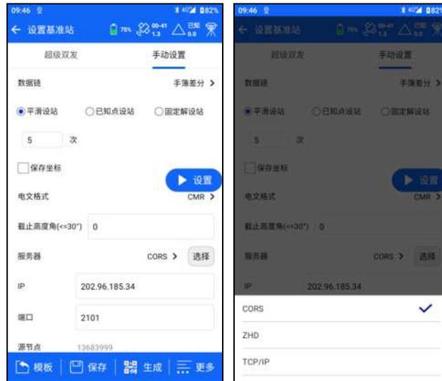
“手簿差分”功能是指手簿网络连接服务器作 RTK，通过手簿的网络模块拨号上网，连接服务器后，将收到的差分数据通过蓝牙转发给主机，从而实现主机无 SIM 卡也可以做网络 RTK。该功能适用于手簿已有网络模块，而且需要经常上网使用的客户。
