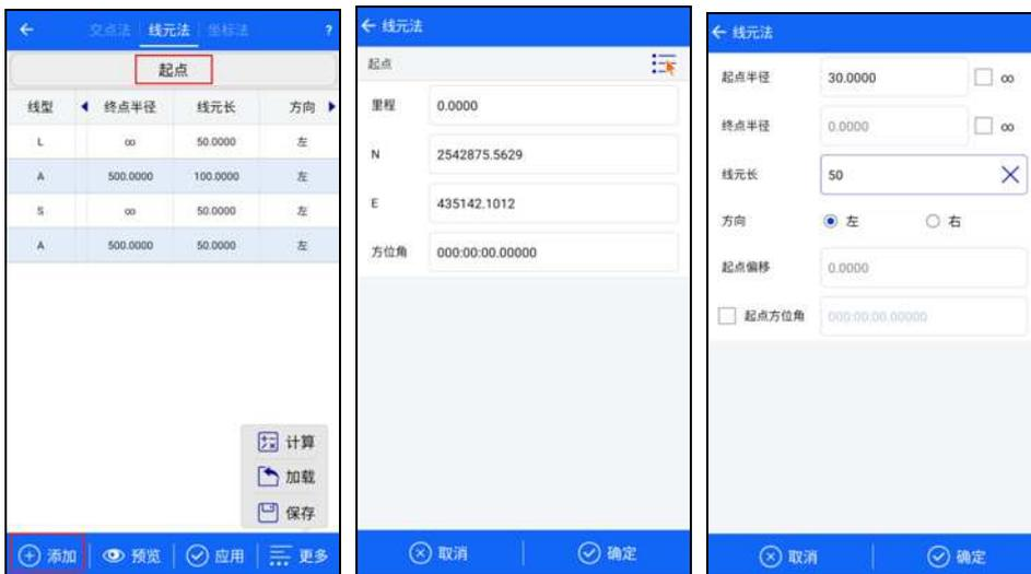
在平断面界面进行创建或编辑交点表数据，并可以点击预览按钮进入查看图形是否正确，右下角方框输入里程数。
