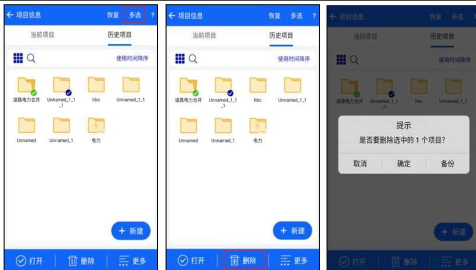
【恢复】可将外置 SD 卡 ZHD-Bak 目录下的项目坐标点、坐标参数和项目信息恢复到软件的工作目录。新建项目和采点时，同名项目目录下的坐标点文件、dam 或二维码坐标参数文件、项目信息文件、横断面点库文件备份在外置 SD 卡的 ZHD-Bak 文件夹中；要使用【恢复】功能必须安装外置 SD 卡！
