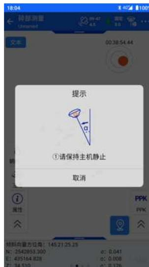
b. 向另外一个方位倾斜，方位跨度  $30^{\circ}\sim 120^{\circ}$  内（方位跨度指：对中杆两个朝向垂直投影地面所形成夹角），并保持静止，完成采集会有“嘀”的声音提示。
