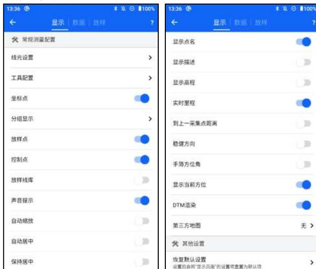
“线元设置”：根据需要配置直线、圆弧、缓曲线元显示的颜色。
