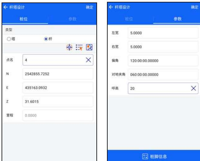
2、选择坑位、分坑，进行分坑放样。首先在第一个下拉框选择是哪个桩，然后在第二个下拉框选择是哪一个坑位；则以坑位到桩位形成一条参考线，软件用蓝色把该线绘制出来，用于帮助用户直观的判断是否行走在参考线上。
