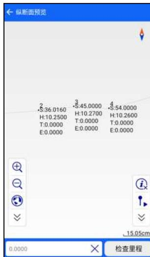
应用：当纵断面设计数据已确定完成加载、编辑之后，点击“应用”将会更新当前最新数据；当所需设计文件全都完成应用后，可点击右上角“确定”，完成道路文件的设计。
