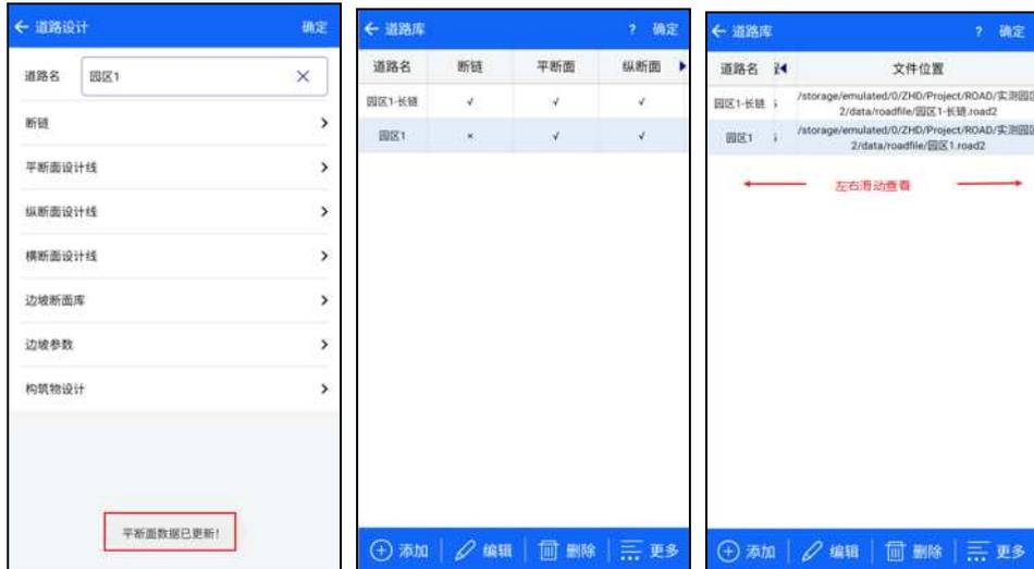
【道路放样】界面右边图标，最上方为切换视角按钮
