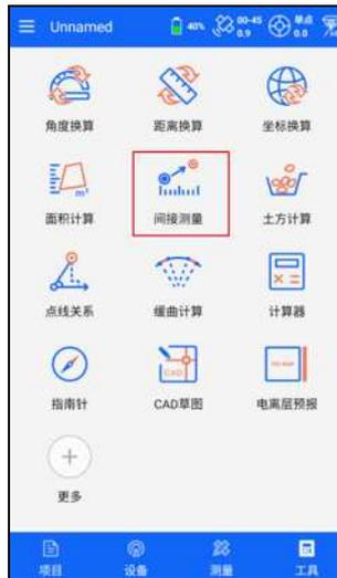
测距仪设备未连接状态下，其中两点两线、两点一线、两点线角及偏心点、两圆相交、圆弧取点均可通过点击测距仪“蓝牙”按钮
