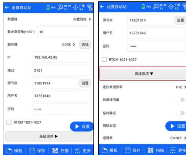
“服务器”：包括 ZHD、CORS 和 TCP/IP，如果使用中海达服务器时，使用 ZHD，接入 CORS 网络时，选择 CORS。
