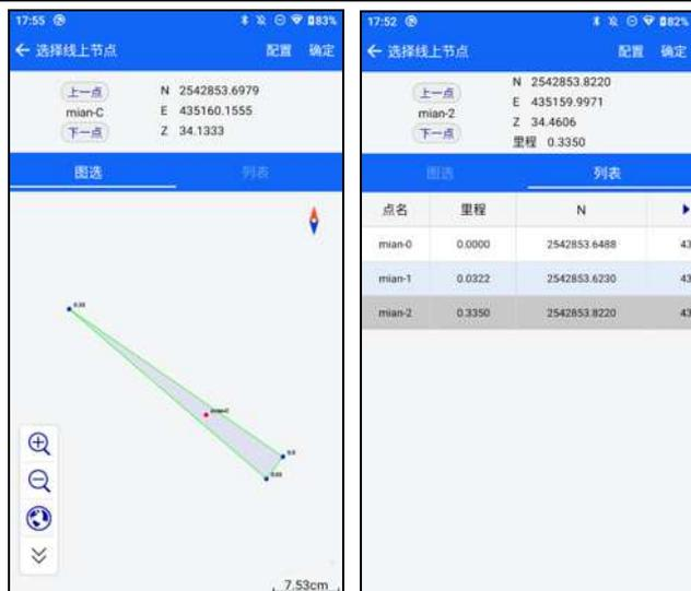
选择线上节点的同时，可以通过【配置】进行线上节点的设置。
