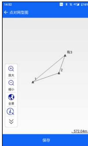
【匹配】 识别坐标点库和控制点库的同名点，并添加为参数计算点对，其中坐标点作为源点，控制点作为目标点。
