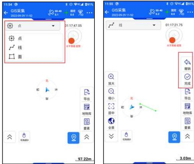
采集完成后跳转采集信息保存界面，此处显示对应要素模板所包含的全部非隐藏标签，输入对应参数后，点击确定即可成功保存要素及要素信息，地图界面显示要素标记及要素对应设置的需显示地图标签。
