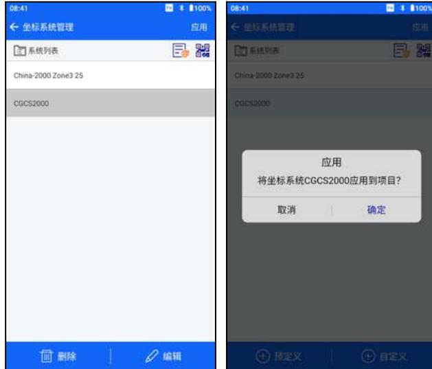
【删除】 / 【编辑】 长按选中系统列表的一项进行删除、编辑，对系统列表中的坐标系统参数进行编辑不影响项目下的坐标系统参数，除非编辑保存坐标系统后点击【应用】按钮。
