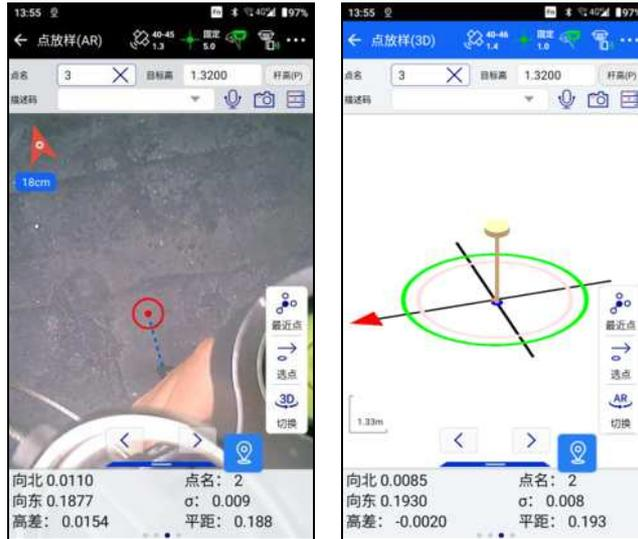
项目加载 CAD 外部数据后（具体操作见本节“[CAD 放样](#)”内容），进入主机 AR 界面，主机副摄像头拍摄画面增加显示 CAD 图形。
