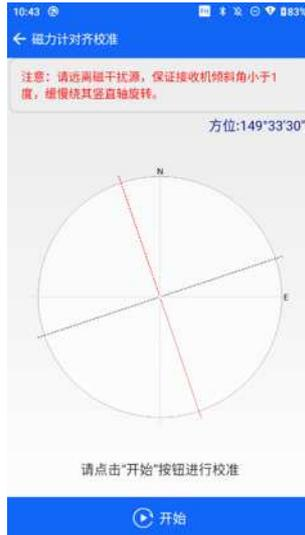
② 点击【开始】按钮开始校准，磁力计对齐校准需要进行水平方向上的校准。
