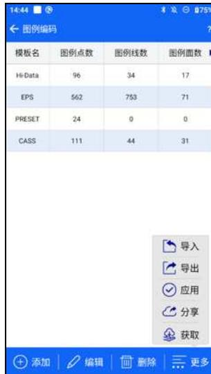
【添加】 新建一个图例模板，设置该图例模板的点、线、面的图例描述及编码。点击“添加”按钮，输入新图例模板名称，进入新建图例模板界面，通过添加、编辑、删除，进一步设置该图例模板的类型、组别及其所属的图例名称、编码、颜色、样式。该图例模板编辑完成后，点击“返回”按钮，根据提示“是否保存数据”，点击“是”，即完成新建图例模板。
