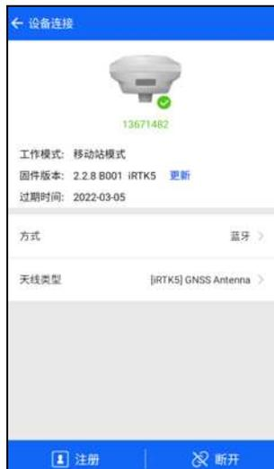
若连接方式为安卓“内置 GPS”，手簿为中海达手簿时显示手簿 SN 号，非中海达手簿显示为空，工作模式、过期时间显示为空，连接方式显示内置 GPS。
