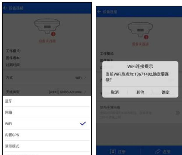
连接方式选择“WiFi”时，设备连接界面显示“使用手簿网络”开关。打开该开关则可使用手簿 SIM 卡网络进行手簿差分数据链设置、联合作业中心登录等需要网络的操作。
