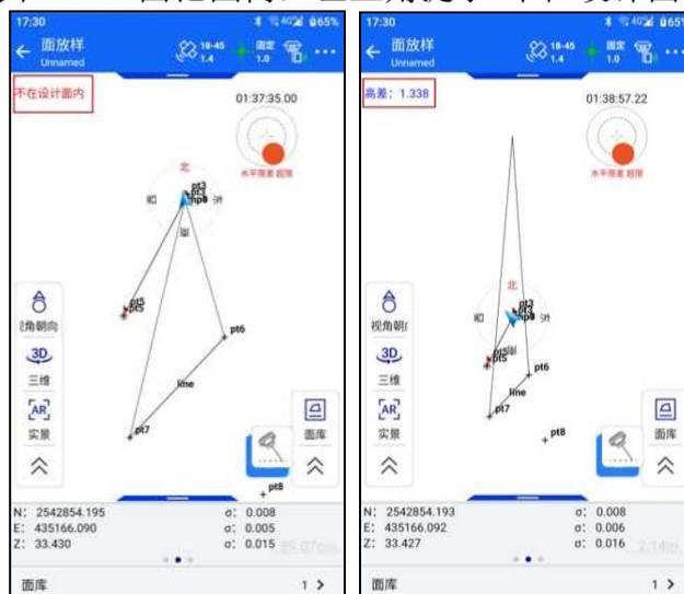
同时也可点击右侧面库按钮
