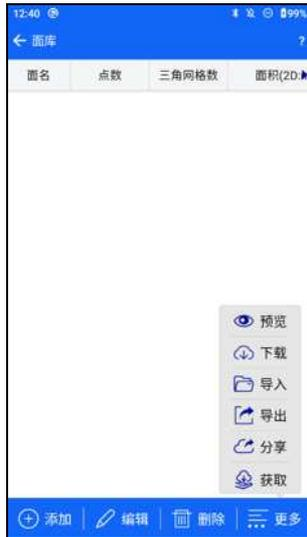
“添加”：添加放样面。包括设置面名、面点名、北坐标（N）、东坐标（E）以及高程，这里的面点信息可以通过实时采集、点库或者图选获取。另外，构建 DTM 面应不少于三个点。
