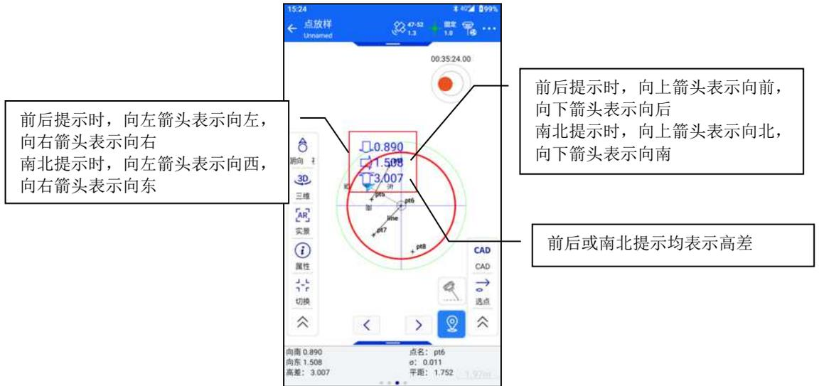
“语音提示”：点、线、道路放样时，进行语音方向和距离的提示。打开语音后会显示语音提示间隔，语音会根据间隔进行提示。(中文版首次打开语音会提示下载资源，进行资源下载，英文版不需要下载资源)
