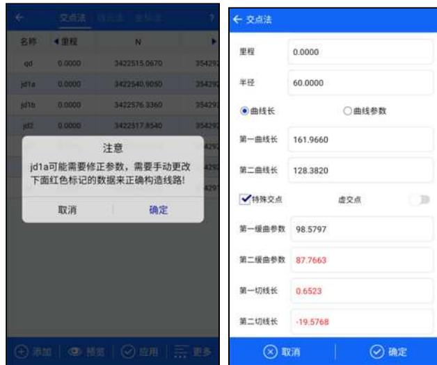
涉及虚交、回头（转向超过 180 度）曲线，除原有线元法可以支持外，在交点法中，支持对应虚交点开关。
