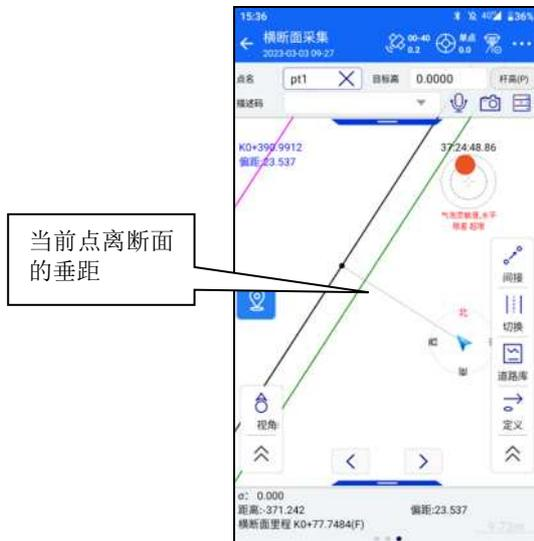
横断面采集时，输入里程，可以唯一定义一个横断面的位置，然后在此断面一定范围内进行采集，处理数据时候能把这些定义为一个横断面的坐标点区别开即可，所以使用软件的时候首先调入道路数据文件（主要是平断面数据），然后输入指定一个里程，软件自动计算该里程处的横断面位置，并在图形上显示一条虚线作为参考线，当靠近此参考线，软件计算
