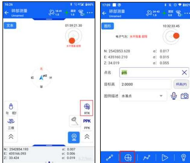
在【辅助功能】--【接收机设置】开启【准动态 RTK 采集】功能后，必须确认连接到差分 30 秒后，才能正常使用，否则将提示：解算引擎准备中。（注意，点击展开按钮后，准动态图标将隐藏。）
