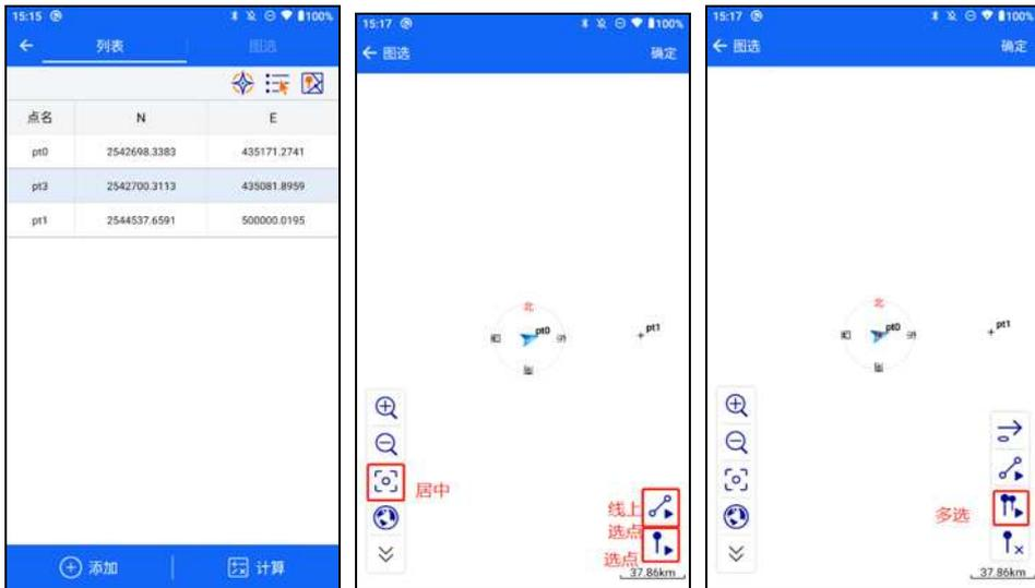
**【图标按钮】** 可通过实时采集、点库、图选的方式将点加入到列表中。
