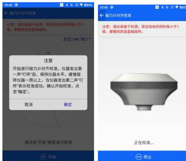
接收机水平放置，以竖直方向为轴顺时针缓慢旋转一周，旋转速度建议不超过  $20^\circ /s$ ，旋转过程中需尽量缓慢匀速旋转，不能有明显停顿。
