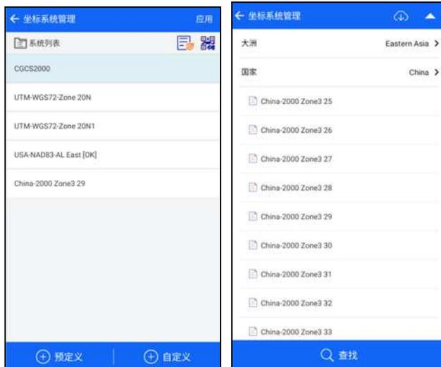
【预定义】 可以加载系统内预定义的坐标系统，系统内按照大洲、国家进行区域分类列出投影列表，您可以根据实际作业区域进行选择。点击右上角的【下载】图标可以从服务器上下载对应的坐标系统和格网文件。
