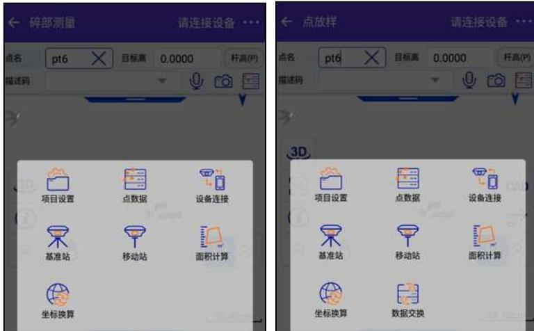
在【基准站/移动站设置】界面点击菜单键
