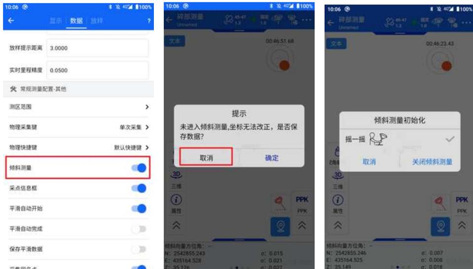
当全部初始化项打上勾后，主机语音播报“进入倾斜测量”，倾斜测量图标被点亮。完成倾斜测量初始化，即可对主机进行倾斜测量操作。
