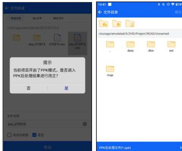
4、文件导入数据进行带号和坐标范围检测（包括【参数计算】的加载，【数据导入】→【放样点】/【控制点】的导入，【线
