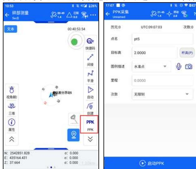
点击【启动 PPK】按钮后, 移动台开始记录静态数据, 到达测量位置输入相应的点名、目标高、图例描述, 选择需要平滑的次数(一般建议 200 次以上)后点击【开始标记】即可进行采集。
