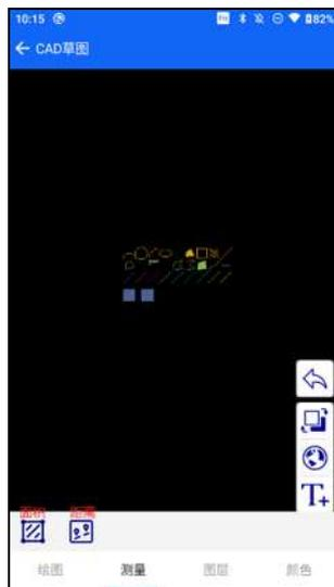
(1) 面积测量：点击显示界面选择第一个顶点，移动选择若干顶点后（至少再选择两个顶点），移动箭头至第一个顶点处，使面积闭合，同时界面上显示该闭合区域的面积及周长
