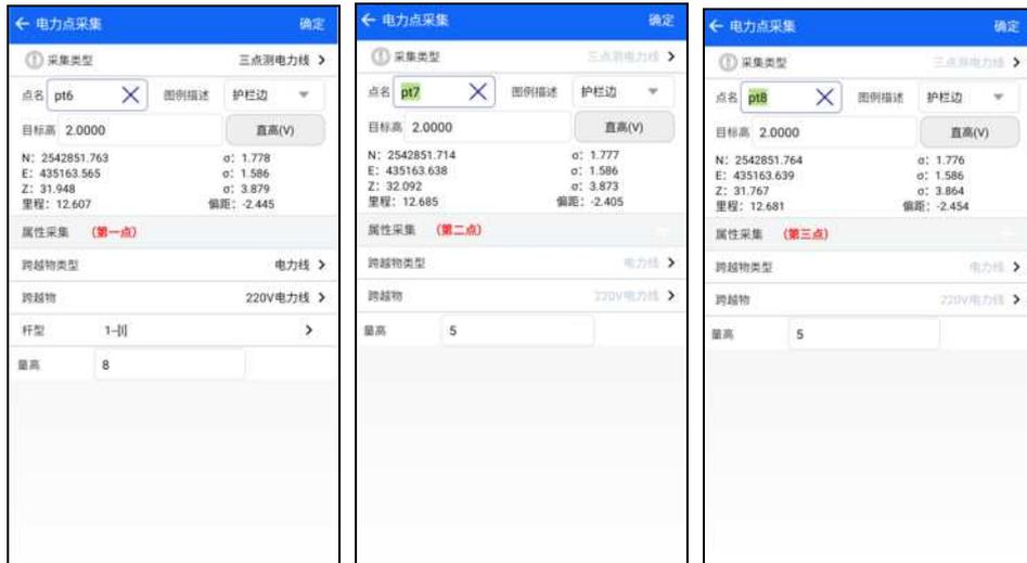
三点测路、河、沟时，第一、第二点确定走向；第一、第三点确定宽度；第一点输入路基高，第二、第三点不用。
