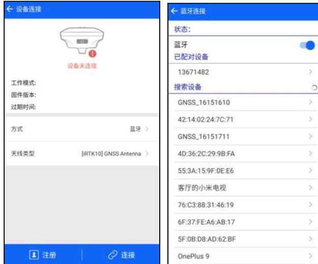
手簿与接收机的连接方式有蓝牙、网络、WiFi、NMEA 通用设备（蓝牙）四种，另外手簿可单独设置内置 GPS、演示模式。
