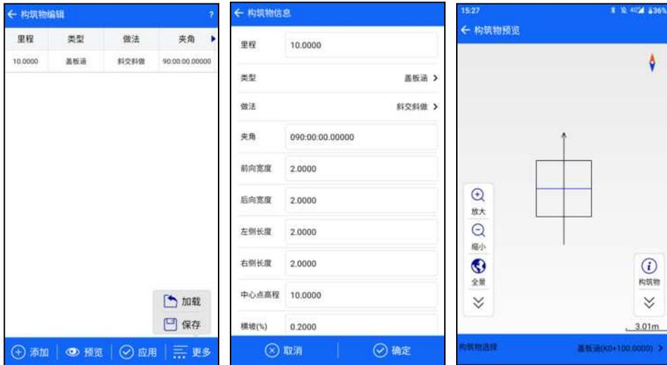
【添加】新建道路构筑物，点击【添加】按钮在构筑物信息界面选定构筑物类型和做法，输入里程值、夹角、前向宽度、后向宽度、左侧长度、右侧长度、中心点高程及横坡，点击【确定】即完成构筑物设计。
