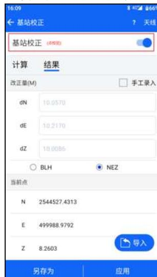
使用基站校正参数采点后，在每一点的坐标点中自动记录所用到的基站校正参数，以便您作业出错时进行 WGS-84 坐标下的大地坐标恢复。在
