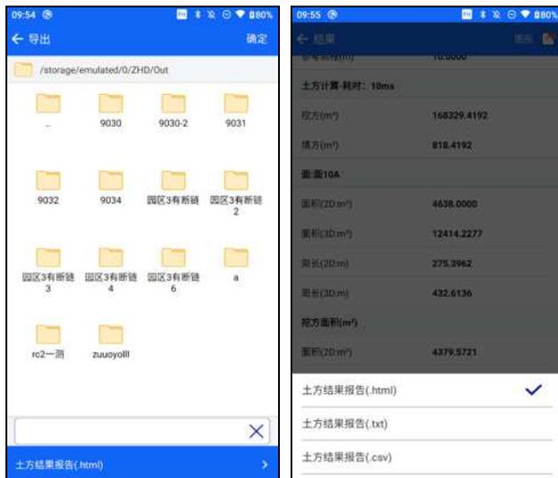
“面积（2D：m<sup>2</sup>）”：投影到水平面上的面积。
