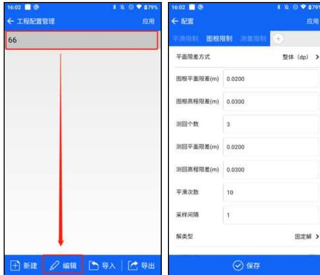
【导入】 可选择对应的工程配置模板文件 (\*.plc)进行导入。
