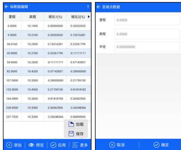
在一般工作过程中，点击添加变坡点数据包括：变坡点里程、变坡点高程、半径（纵曲线半径）、按照里程顺序依次添加完线路所有变坡点的要素。
