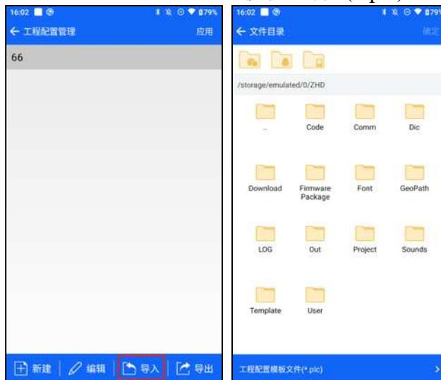
【导出】 在工程配置管理列表中，选中要导出的模板，单击“导出”，选择该模板导出格式(工程配置模板文件 (\*.plc))，并输入对应的名称(默认文本框填充模板列表中的名字)，即可进行导出。
