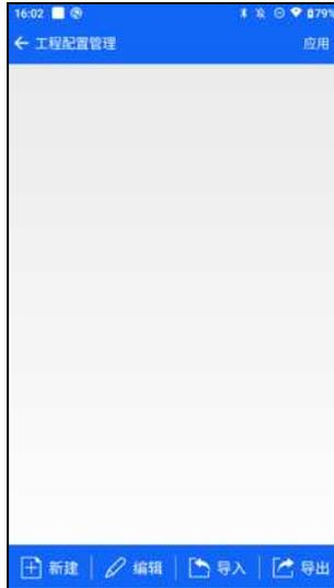
【新建】新建一个工程配置模板，对平滑采集、图根测量、测量精度的参数进行更改。点击“新建”按钮，输入新工程模板名称，进入工程配置界面，通过添加、编辑、删除，进一步设置该工程模板的内容。该工程配置模板编辑完成后，点击“返回”按钮，根据提示“是否保存数据”，点击“是”，即完成新建工程配置模板。
