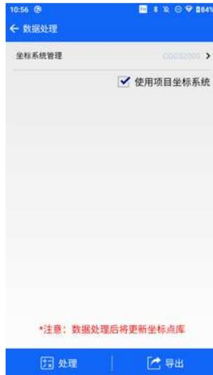
⑤ 【数据交换】-坐标点自定义导出，支持导出未加倾斜改正的平面坐标（倾斜 N、倾斜 E、倾斜 Z 即为未改正的平面坐标字段）。选择导出路径并输入导出文件名，完成自定义格式设置后点击【确定】导出。
