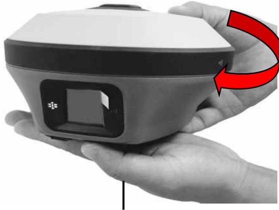
③各个方向校准完毕，仪器发出第二声“叮咚”提示“操作成功”，校准完成。若提示校准失败则重新校准。
