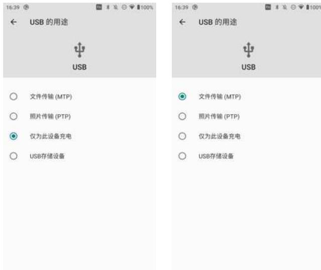
3、如需在电脑上同步操作手簿或安装使用第三方软件进行数据调试，需勾选“USB 调试”功能。打开手簿，在桌面菜单中点击【系统设置】→【开发者选项】→【USB 调试】。（新手簿第一次使用时，需要在“关于手簿”界面点击三次版本号才能开启“开发者选项”）
