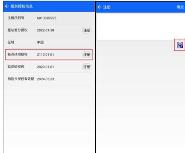
“物联卡授权有效期”：点击“物联卡授权有效期”，软件从主机请求物联网卡有效期并显示查询进度动画；获取主机回应的过期时间后显示在界面上。仅支持 V96 仪器支持该功能。若未插入物联网卡，则显示“未检测到物联卡”；若存在异常状态导致得不到有效数据，则显示“查询失败”。
