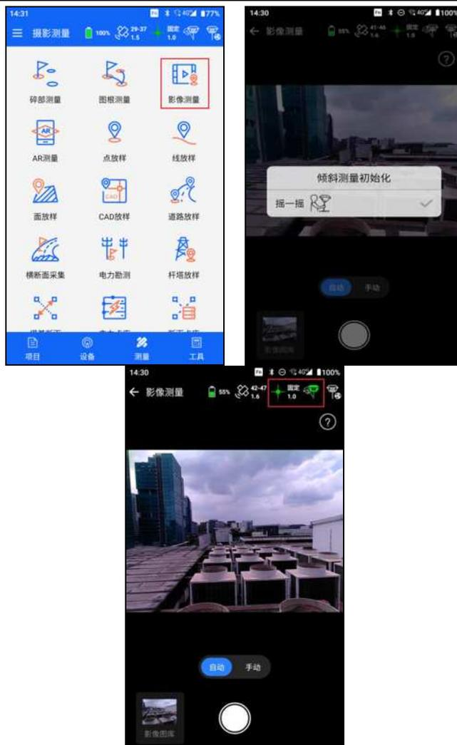
在距离待测物合适位置（一般距待测物 2m-15m 较为合适）绕其进行弧形轨迹的拍摄，建议最后分别走近和远离待测物各拍摄一张照片，以达到较好的精度，具体见“[影像 RTK 拍摄示意图](#)”章节。至少需要拍摄 3 张合格的照片才能点击结束。
