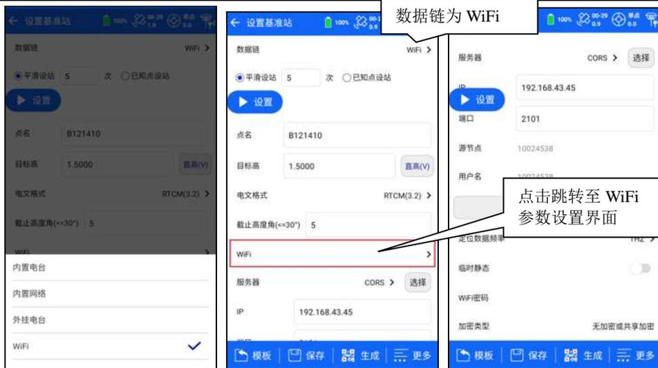
当 WiFi 参数设置界面的“使用手簿 WLAN 热点”为开启状态时，支持连接作业手簿 WiFi 热点，否则将连接第三方 WiFi 热点。注意，如果当前使用 WiFi 连接的主机，则不会出现 WiFi 数据链选项。
