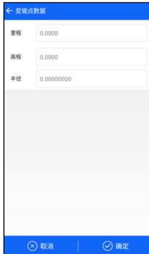
加载：加载已编辑好或已保存的变坡点文件。
