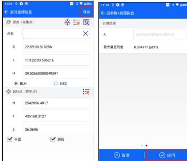
添加完两个以上的点对后，点击“计算”，显示计算出来的“四参数+高程拟合”的结果，主要看旋转和尺度。四参数的结果平移北和平移东一般较小，旋转在 0 度左右，尺度在 0.9999-1.0000 之间（一般来说，尺度越接近 1 越好），平面和高程残差越小越好，确认无误后点击“应用”，软件将自动运用新参数更新坐标点库。
