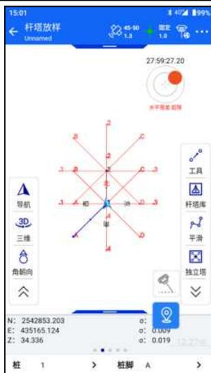
对于拉线坑的放样，这里实时显示出当前位置形成的对地交角（单位：度），以此帮助用户控制拉线的三维空间形态；
