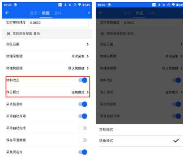
② 未开启倾斜测量时，软件不进行倾斜改正，软件测量界面显示和坐标点库记录倾斜点的坐标；开启倾斜测量，则软件测量界面显示和坐标点库记录归算至地面测量点的坐标。
