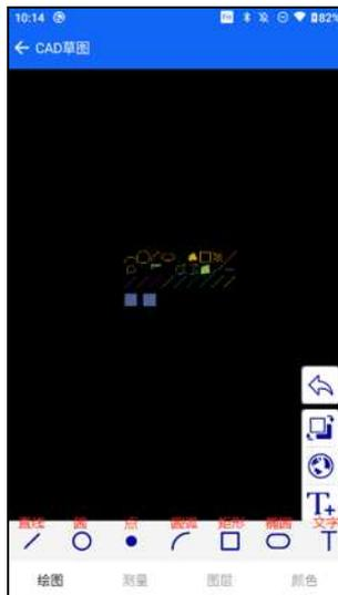
(1) 直线：点击显示界面选择直线起点，移动选择直线终点，松手绘制成功
