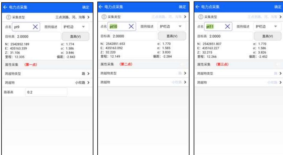
三点测房时，第一、第二个点表示房屋的长同时用于定向，第二、第三个点用于表示房屋宽，屋顶类型和房屋高在第一个点采集的时候在属性栏填写。
