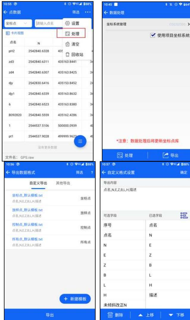
数据处理后的数据可以进行导出，导出内容可以在创建自定义导出模板时可选字段中选择。导出文件目录中如有同名文件会提示“同名文件已存在”，可勾选“覆盖”原有数据或输入新的文件名，点击“确定”导出。
