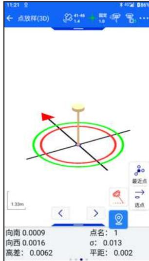
【影像 AR 放样】：连接一台支持影像放样的主机后，进入点放样界面，选择放样点后，点击影像 AR 放样按钮
