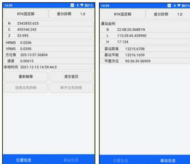
**【重新解算】** 移动站重新将接收到的基准站的差分数据进行解算，一般在卫星条件较差的情况下，可通过多次重新解算，保存坐标，排除带有多路径干扰的不正确的解。
