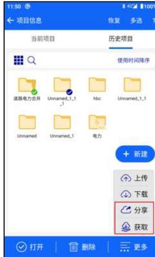
【搜索】点击搜索图标，显示项目搜索框，输入关键字可进行项目名称模糊搜索，界面仅显示包含关键字的项目，可对搜索结果项目进行打开、删除、多选删除、上传下载、分享获取等操作。
