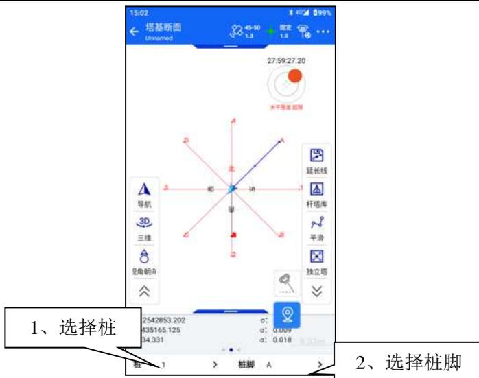
在进行塔基断面测量时，需先进行塔基断面定义，最多可定义 12 个塔基断面线；选择塔基及塔角后，按照提示进行断面测量，数据保存在断面点库 (\*.stsp) 中，断面点库文件可用 Hi-Convertor II 转换成道亨格式进行断面成图。在编辑电力塔杆时，可根据用户需要，添加桩脚 ( $<45^\circ$ )。
