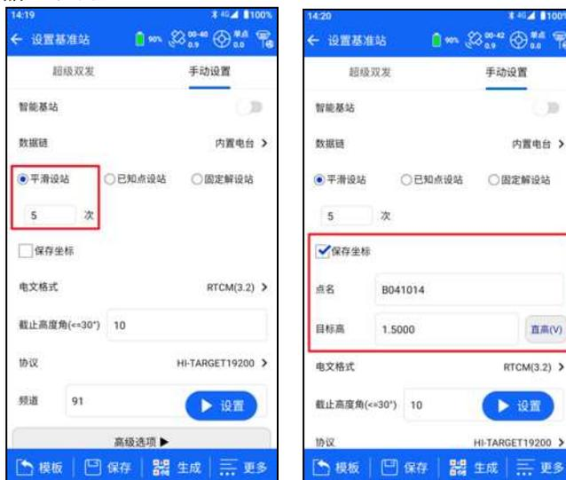
③如果基准站架设在未知点上，选择【固定解设站】，点击悬浮按钮“设置”，接收机将在后台主动设站并达到固定解后获取固定解坐标作为基准站坐标进行基准站设置。
