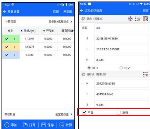
四参数+高程拟合计算下点对坐标信息输入可以设置具体类型：
