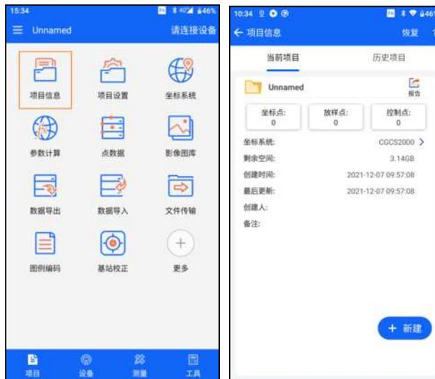
【新建】点击新建按钮，进入新建项目页，输入项目名（必填）、创建人、备注等信息，选择所需的坐标系统和图例编码（可以选择直接套用已存在的项目或者手动选择，两者不可同时选择，套用项目时还可以选择套用道路文件或道路文件），确认无误后点击确定完成新建项目。
