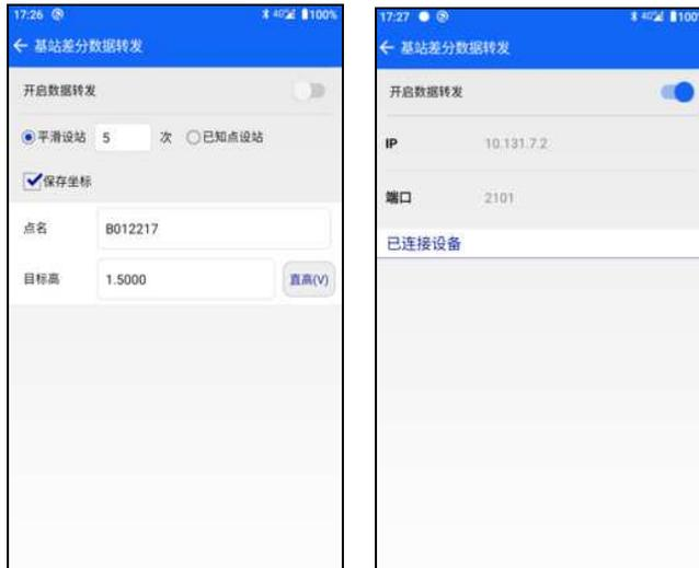
2.连接移动站的手簿设置主机为移动站手簿差分 Cors，其中 IP 端口填写上述“基站差分数据转发”界面显示的 IP 端口，源节点输入基站 SN 号或 RTCM32，输入用户名密码（密码默认 zhdgps），即可获取到转发的差分数据并达到固定。
