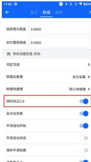
此模式下在【碎部测量】界面点击采集按钮，软件将会提示请晃动主机完成测量，此时只需匀速晃动主机等待进度条达到100%，即可完成采点。
