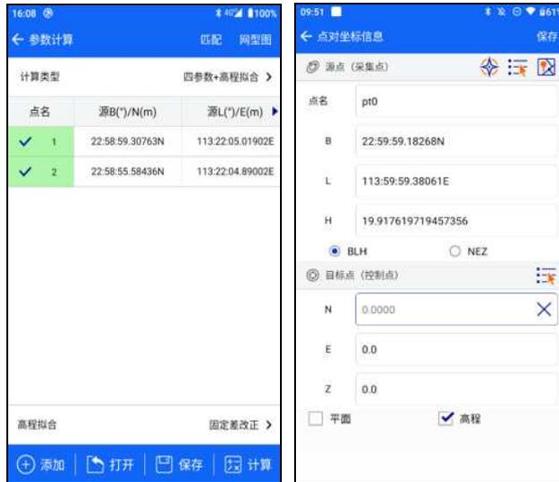
【添加】 添加点的源坐标和目标坐标，源点坐标可手动输入或实时采集、点库、图选方式获取（默认选择 BLH），目标点坐标可手动输入或从点库中获取。参数计算时进行单点或平滑采集点，并支持数据存储（保存至坐标点&坐标点点库）。输入后点击“保存”，若需要对已有的点信息进行操作时长按选中该行点信息进行编辑或者删除。
