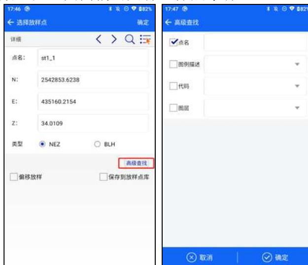
【放样最近点】终端用户点击
