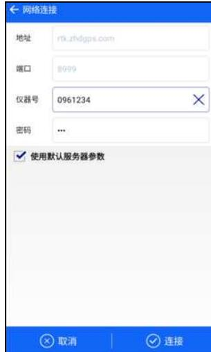
若连接方式为“WiFi”，如果当前手簿没有连上任何 WiFi 热点，将自动跳转至 WiFi 连接界面，您可手动选择主机 WiFi 热点连接（确保当前接收机 WiFi 热点已开启），成功连上热点后即可直接连接主机；如果当前手簿已经连上一个 WiFi 热点，将提示您继续连接还是选择其他热点连接，您可根据提示信息自行判断，连接其他热点方法同上所述。若初次连接主机 WiFi 需输入密码，初始密码为 12345678，已连接的设备不需再输入连接密码。
