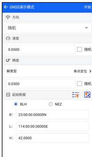
“方向”：有线路、地图、输入、随机四种方式，可根据需要任意选择。
