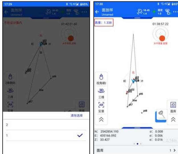
高差图形界面左上角实时显示控制高程和计算出来的高差，如果当前点投影不在选中 DTM 面范围内，左上角提示“不在设计面内”。
