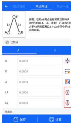
进入测距仪界面后，点击界面下方的“连接”按钮，通过蓝牙连接测距仪，即可用测距仪测量相应数值。
