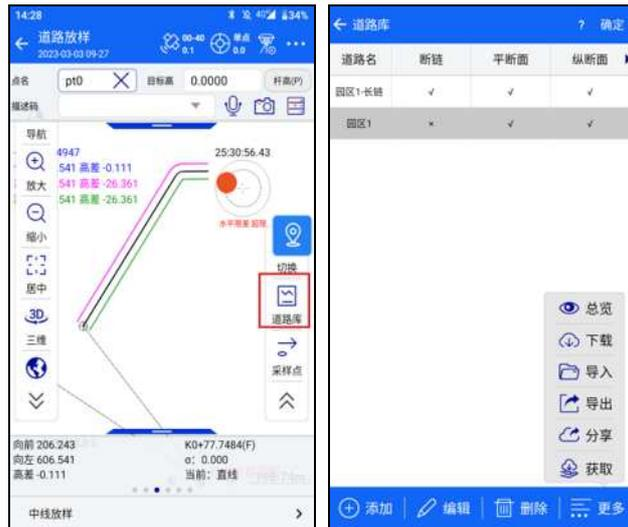
(2) 若选择新建道路时，可以通过道路设计界面，分别导入路线的断链、平断面、纵断面、横断面以及边坡断面、边坡参数、构筑物设计文件，每一个文件导入后点击对应文件界面的【应用】。
