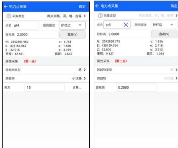
若点击“属性采集”后的
