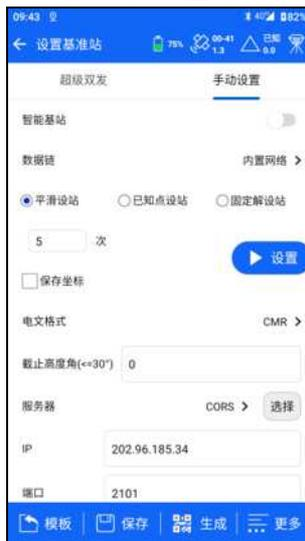
“服务器/IP”：选择服务器，手动输入 IP，端口号，也可以点击“选择”，弹出服务器地址列表，可从列表中选择所需要的服务器。目前中海达已有多个网络服务器和服务器端口供您使用，并可自行选择服务器及端口。
