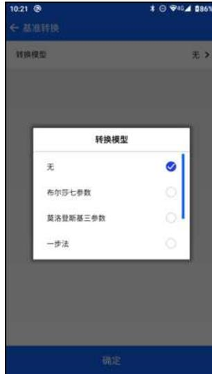
【基准转换模型】可选转换参数有：无、布尔莎七参数、莫洛登斯基三参数、一步法、多项式回归模型及十参数。
