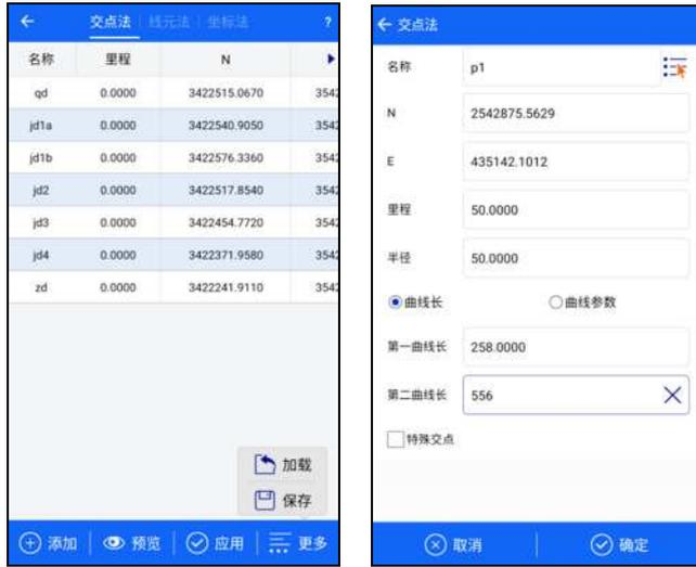
【添加】 添加交点数据，从直曲表获取交点名称、N、E、交点里程（只需录入前两个点的里程）和圆弧半径、第一缓和曲线长、第二缓和曲线长，若有交点对应的半径和曲线长，则输入；若无，则不输入。
