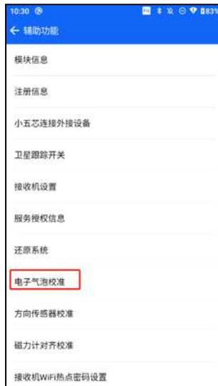
②仪器安放的基座严格整平后，点击【开始】按钮进行校准，在弹出的提示框中点击【确定】。
