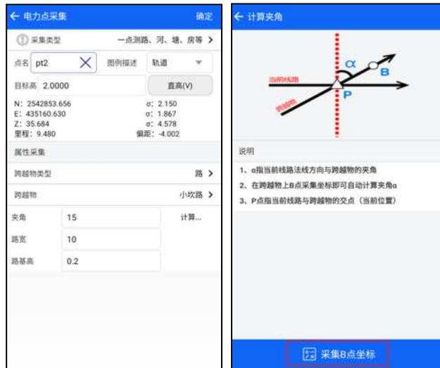
跨越物角度输入时可计算，点击角度后面【计算】按钮即可进入夹角采集界面，根据界面提示信息点击【采集 B 点坐标】即可计算出夹角并更新至电力点采集界面。
