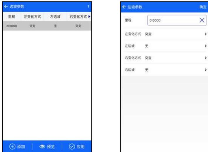
【编辑】用户选中某项边坡参数，点击【编辑】按钮，软件进入边坡参数详细编辑界面，用户对边坡参数进行修改后点击【确定】，软件进行边坡参数合法性检测，若通过检测即可保存成功。
