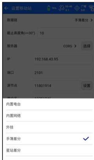
移动站使用“内置电台”功能：只需设置数据链为内置电台，修改电台频道，电台协议、空中波特率。电台频道必须和基准站一致。
