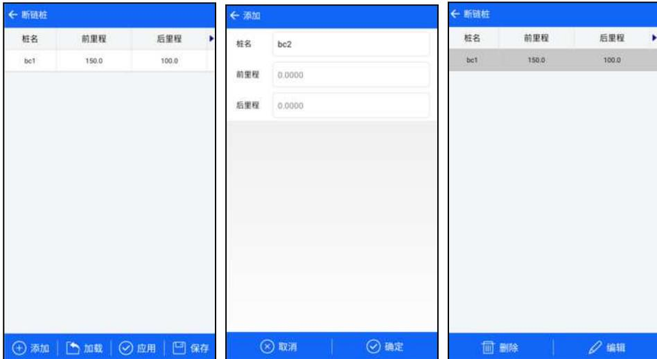
【添加】点击“添加”按钮，可通过软件添加断链桩。编辑桩名，输入前里程和后里程，点击“确定”，添加完成的断链桩可在断链桩列表下查看。
