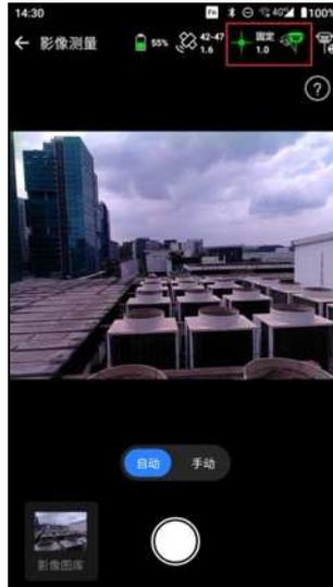
在距离待测物合适位置（一般距待测物 2m-15m 较为合适）点击拍摄按钮绕其进行弧形轨迹的连续拍摄，拍摄频率为每秒两张相片。至少需要拍摄 3 秒钟以上方可点击拍摄按钮结束。
