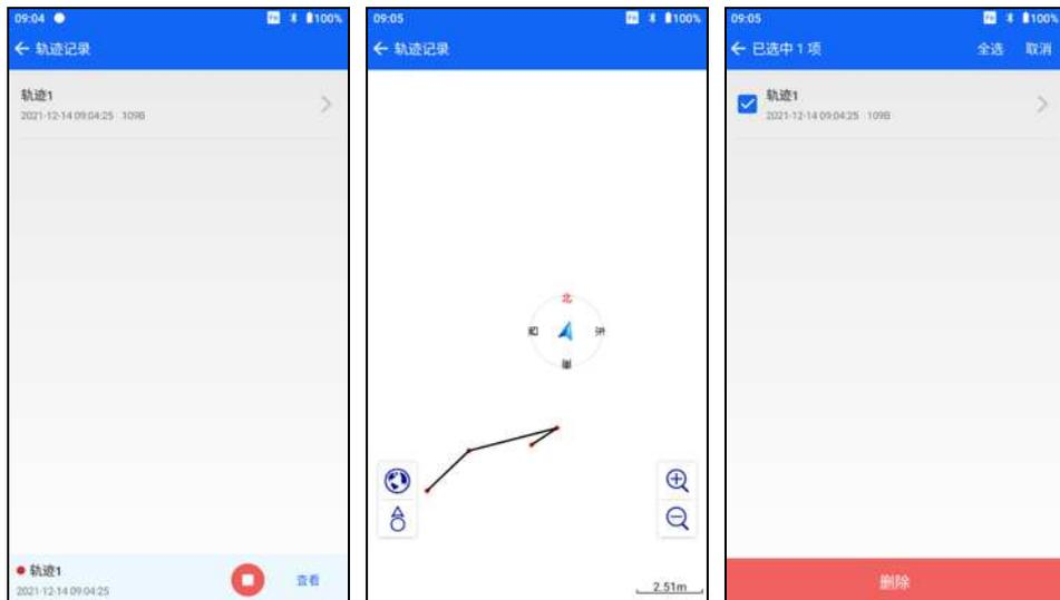
**【新建】**：连接主机后，点击新建，软件会弹出轨迹设置框。需填写轨迹名称以及设置轨迹采集间隔。采集间隔可设置“按时间”（最小 10 秒）以及“按距离”（最小 1 米）。参数设置完毕后点击“开始”，即可开始记录轨迹。
