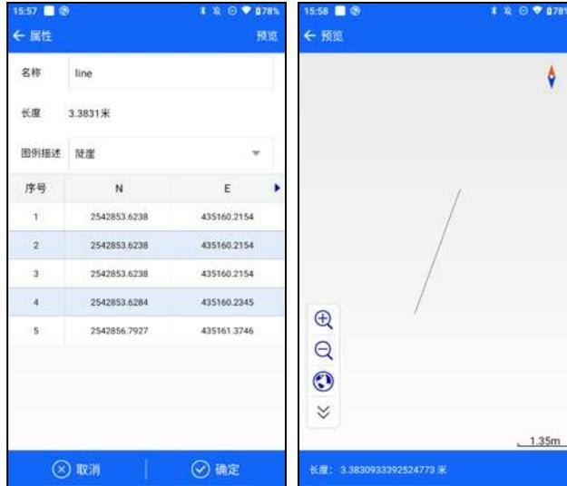
进入属性界面，长按构成线/面的坐标点，可进行删除、上移、下移、插入、编辑操作。其中操作插入、编辑项，可通过列表、图选、实时采集或手动编辑的方式补充坐标信息。
