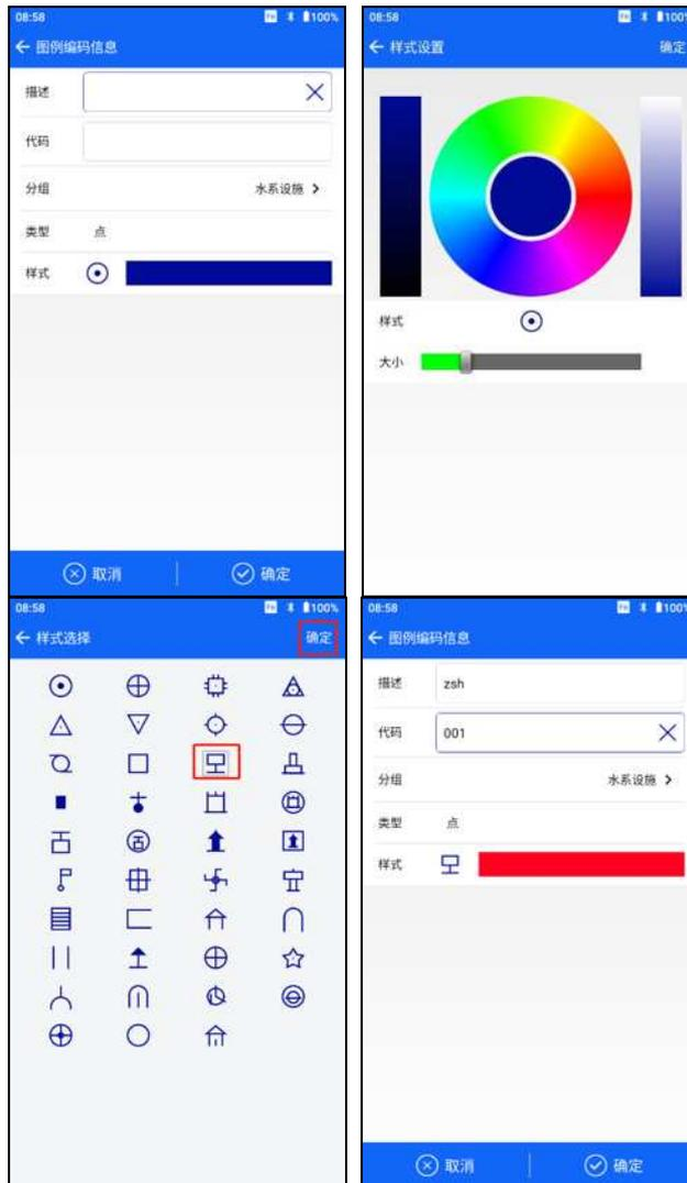
**【编辑】**：对已存在的图例编码进行重新编辑、修改。编辑方式与**【添加】**类似，除了不能对该图例编码的名称进行编辑外，可对其代码、分组及图例样式进行修改，最后点击“确定”即可。
