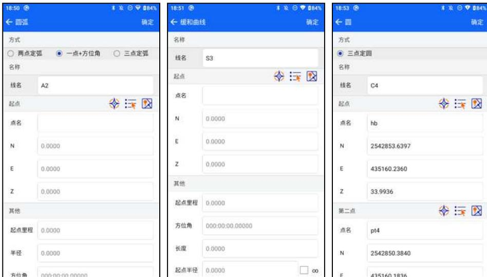
当添加【圆弧】，选择【两点定弧】方式时，软件会显示【以起点-终点命名】选框，勾选选框后，软件会自动以“起点-终点”方式命名线名，同时不能编辑线名，并一直记录选框状态。当您再次点击选框，软件取消自动以“起点-终点”命名方式，但不修改原有线名。
