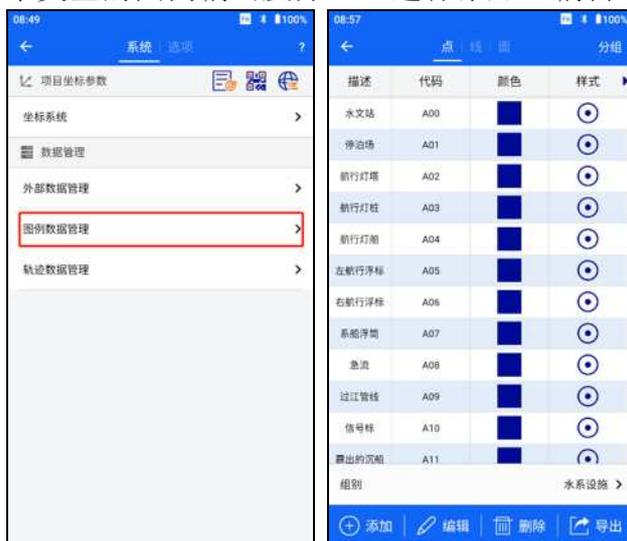
对图例编码进行操作前，应先确定所需操作的类型（点、线、面），再确定该类型下的组别（例如：水系设施、土质或居民地、无分组等），最后在该类型的组别下进行图例名称、编码、颜色及样式的添加、编辑和删除操作。
