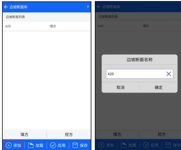
**【加载】** 点击“加载”按钮，软件进入文件选择框，默认进入路径为 ZHD/Project/ROAD 下。您可选择要加载的边坡文件(\*.BPI)，点击“确定”，加载成功后，边坡断面列表显示当前文件中的所有断面信息。
