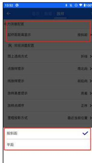
常规测量配置包括：图上选线方式、点放样提示、线放样提示、放样高差提示、放样点顺序、里程投影方式、实时里程放样、图上提示、语音提示、接近点提示、是否重复放样、点放样采集点名、点放样采集描述、线/路放样采集点名、线/路放样保存里程，以及上一点/下一点悬浮按钮。
