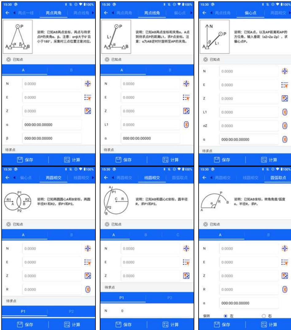
其中两点两线、两点两角和两点线角这三种方法按理论定出 P 有两个位置，如果按顺序先输入 A 点位置的坐标再输入 B 点位置的坐标，则 P 点就位于 AB 连线的上方；如果先输入 B 点位置的坐标再输入 A 点位置的坐标，则 P 点就位于 AB 连线的下方。
