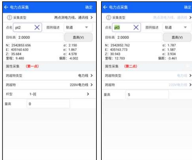
【两点测路、河、塘、房等】是两点测的第二种方式，可以较精确的测量实物宽度。首先，在实物一端点击“采集”，采集类型选择两点测路、河、塘、房等，属性采集处提示为第一点，选择跨越物类型、跨越物输入夹角（可通过【计算】获得夹角值）；保存后，再到实物另一端点击直接采集
