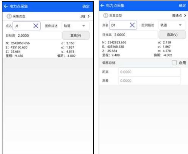
作业过程中,首先,根据需求选择参考线;其次,采集电力点,在需要采集的地物点,选择采集点类型,选择杆型,输入宽度、角度、量高等信息;最后,点击【确定】存储测量数据,电力软件会将这些地物信息及属性,保存到测量文件中。不用记录繁琐的编码,直接通过选择的方式,就把地物及属性记录下来。
