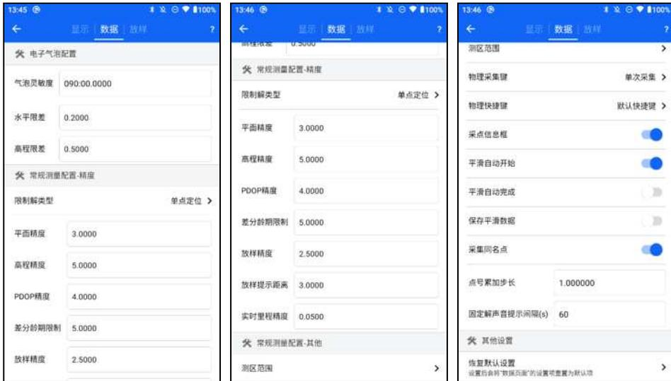
“电子气泡配置”：设置电子气泡采集精度。配置项包括：气泡灵敏度、水平限差和高程限差。
