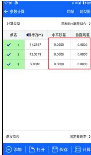
**【应用】** 将当前计算结果应用到对应的坐标参数，参数计算结果应用至当前项目时更新坐标点库。
