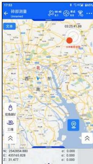
“离线地图”：选择百度地图后，显示“离线地图”入口。下载测量地区的地图后，无网情况下第三方地图能正常显示（英文状态下不支持）。
